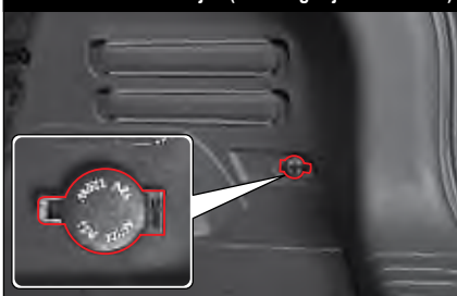
Elektromos csatlakozóaljzat (a csomagtér jobb alsó része)
